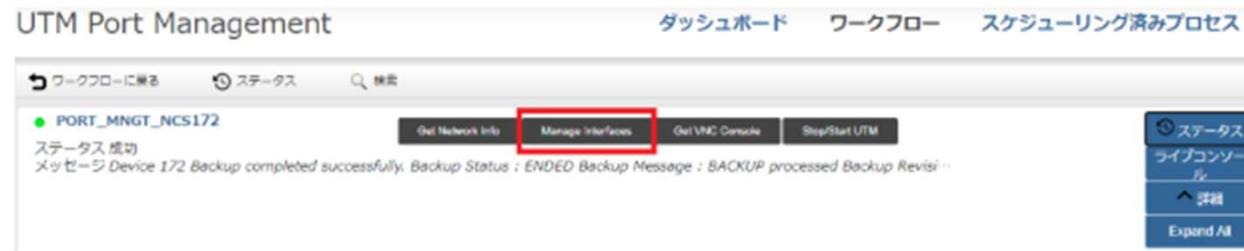
[Manage Interfaces] の画面が開きます。Port 2,3は [Manage Interfaces] の画面には表示されません。設定対象のポートをクリックで選択して、[編集] をクリックします。
